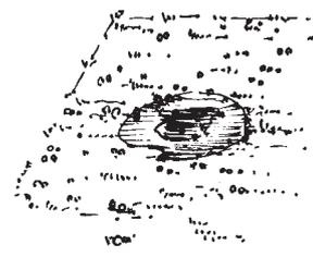
Fahrspuren oder Pfützen entstehen auf offenporigen Belägen bei zu geringem Frostschutz-Unterbau oder fehlendem Entwässerungsgefälle (mindestens 3 %).
